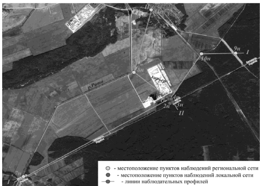
Рисунок 1 – Схема расположения пунктов наблюдений мониторинга подземных вод в пределах белорусской части зоны воздействия отработки II очереди месторождения «Хотиславское» по состоянию на 2022 г. ( www.google.by/maps )
