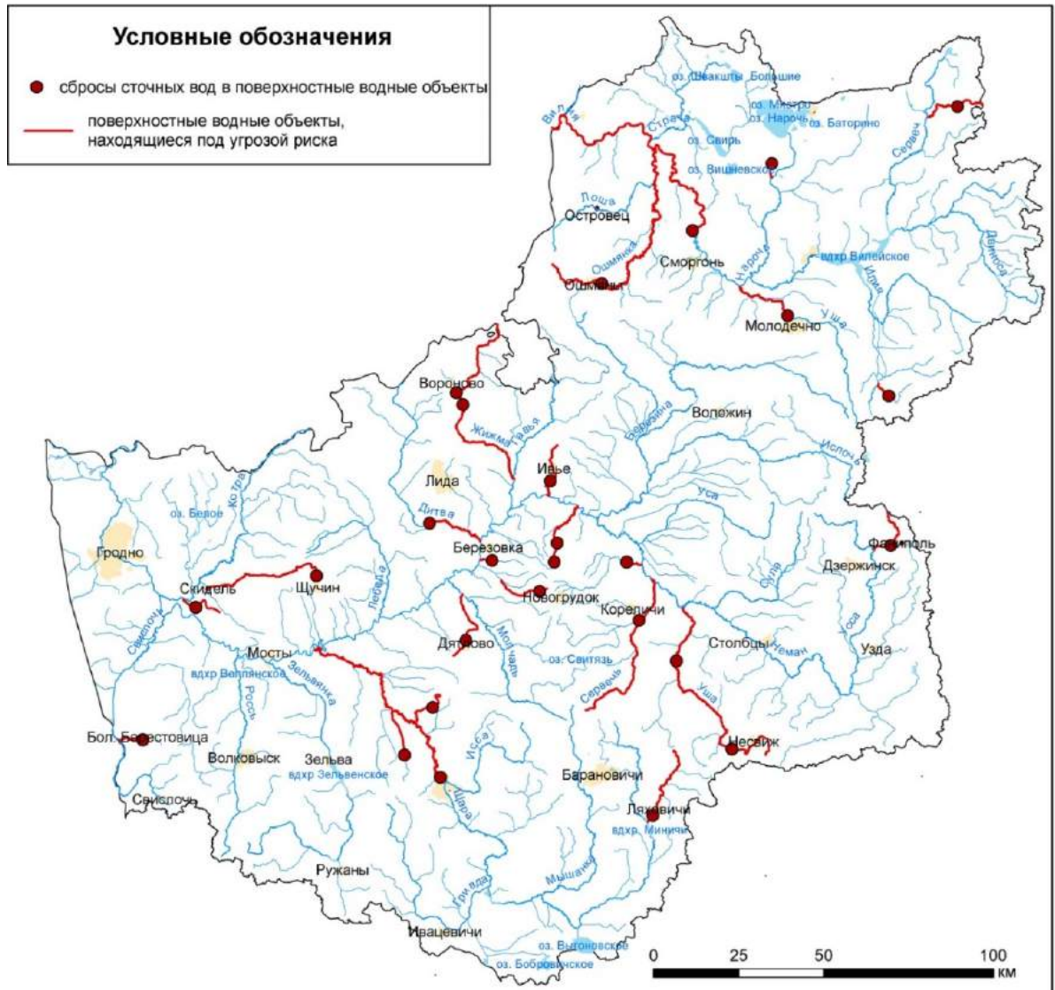
Рисунок 3.4 – Схема водных объектов бассейна р. Неман, находящихся под значительным воздействием точечных источников загрязнения
